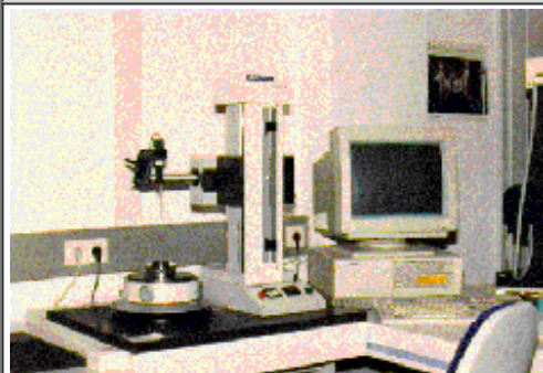
Geometrieprüfung mit Tastschnittgeräten 2D-Auswertung (Kontur)...
